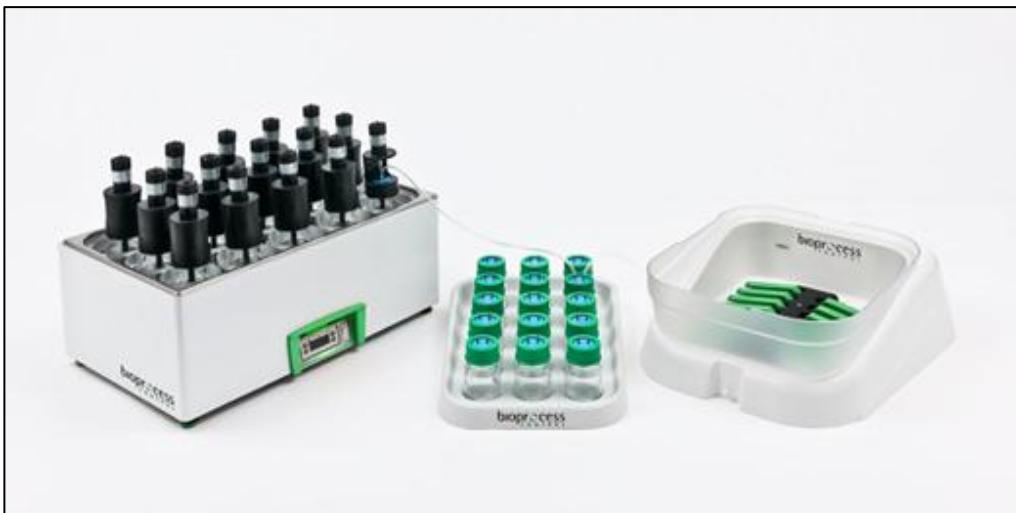
**Slika 7:** AMPTS (z leve proti desni: reaktorji v vodni kopeli, enota za kemično absorpcijo  $\text{CO}_2$  in  $\text{H}_2\text{S}$ , enota za merjenje količine nastalega bioplina oz. metana
