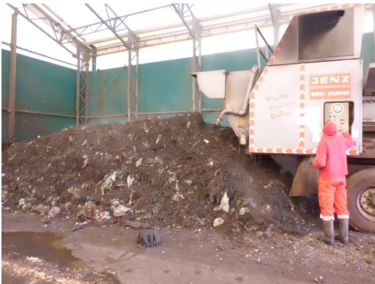
Slika 14: Prikaz prvega mletja kompostne kopice s še vidnimi delci vrečk iz kompostirne plastike
