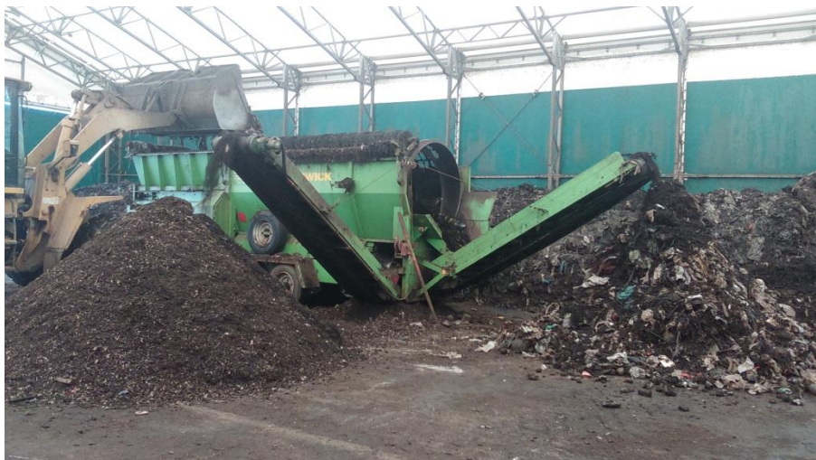
Slika 18: Sejanje kompostne kopice s prvim presevkom na desnem kupu
