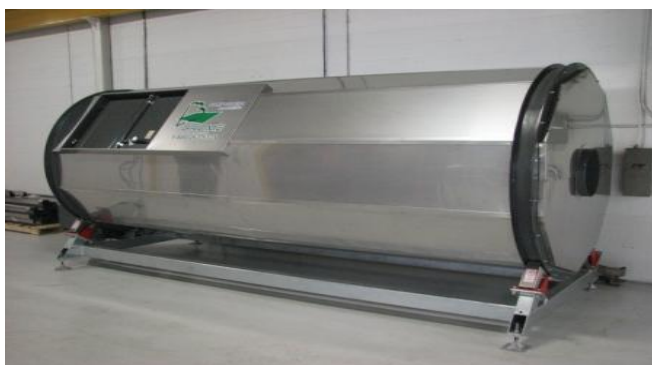
Slika 2: Prikaz načina kompostiranja v rotirajočem bobnu (Vir: Groupe Commercial Paul Larouche)
