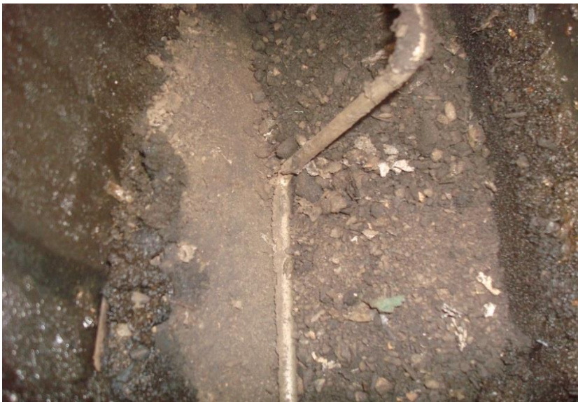
Slika 34: Prikaz celice laboratorijskega kompostiranja biorazgradljivih plastičnih vrečk po 9 tednih poskusa
