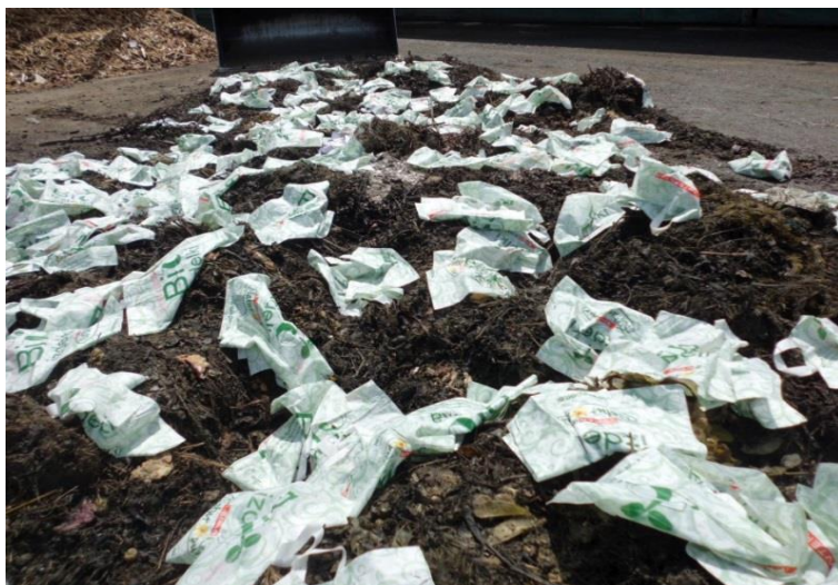
Slika 12: Pripravljanje kompostne kopice z vstavljenimi vrečkami iz biorazgradljive plastike
