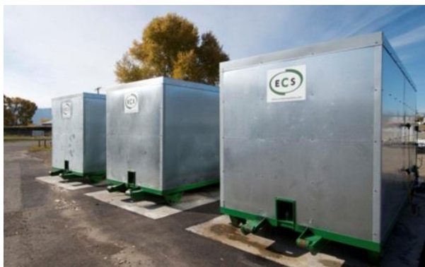
Slika 1: Prikaz zaprtega načina kompostiranja v celicah (Vir: Engineered Compost Systems, Inc.)
