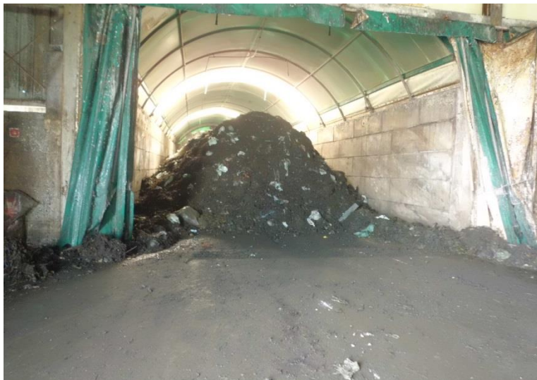
Slika 13: Pripravljena kopica v tunelu z vmešanimi biorazgradljivimi vrečkami
