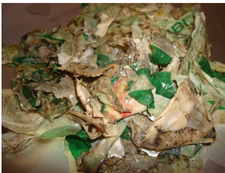
Slika 17: Sprani delci vrečk iz biorazgradljive plastike po približno 7 tednih in pol kompostiranja
