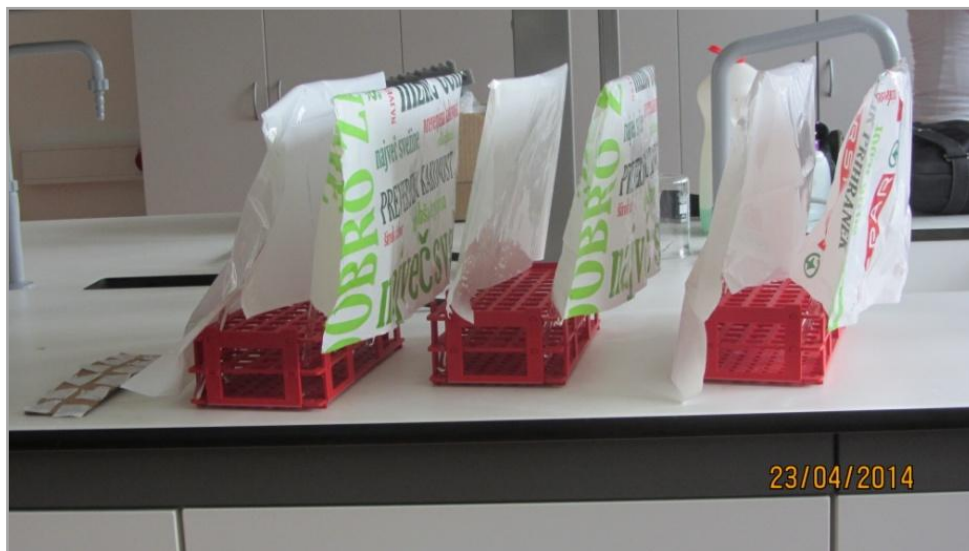
Slika 8: Vzorci polietilenske folije 1 in 2 pred izpostavitvijo pospešenemu staranju
