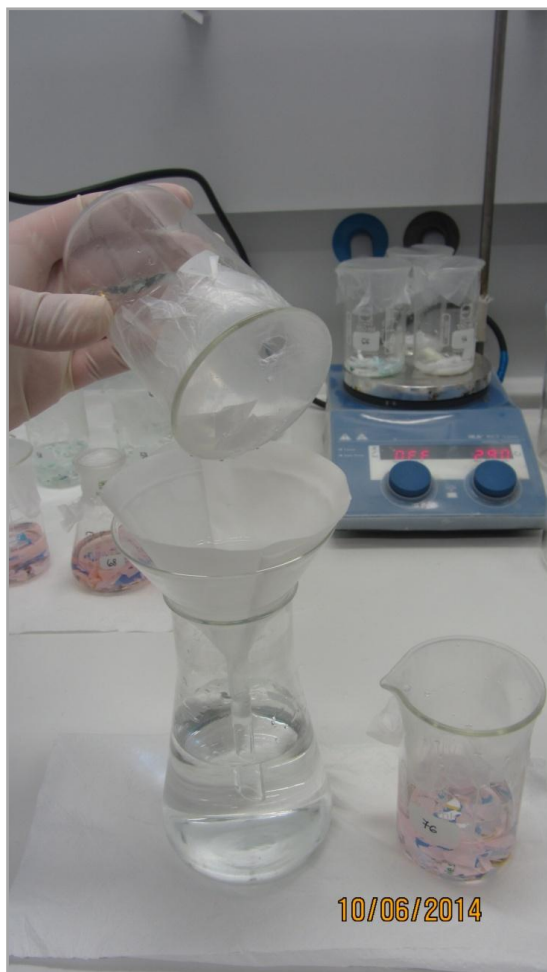
Slika 9: Odlivanje raztopine skozi lij preko parafilma in filter papirja
