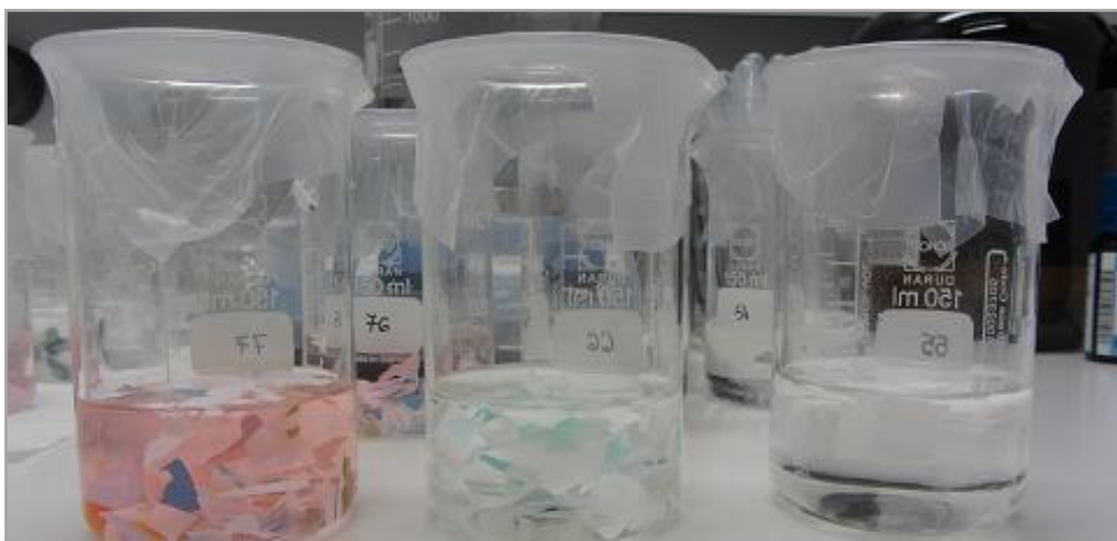
Slika 25: Substrati v vodnem stolpcu: neznano star oksidativno razpadljivi polietilen (levo), polietilenska folija 2 (sredina), polietilenska folija 1 (desno)
