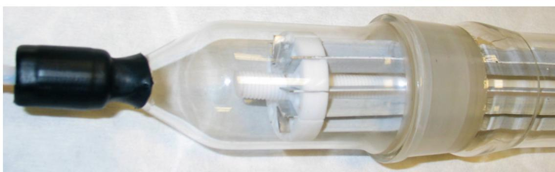
**Slika 12:** Fotografija plinske celice s teflonskim nosilcem z aluminijastimi ploščicami in nanešenim katalizatorjem
