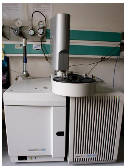
**Slika 15:** GC-MS analizator
