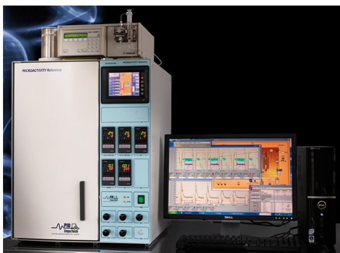
Slika 8: Reaktor za katalitsko mokro oksidacijo
