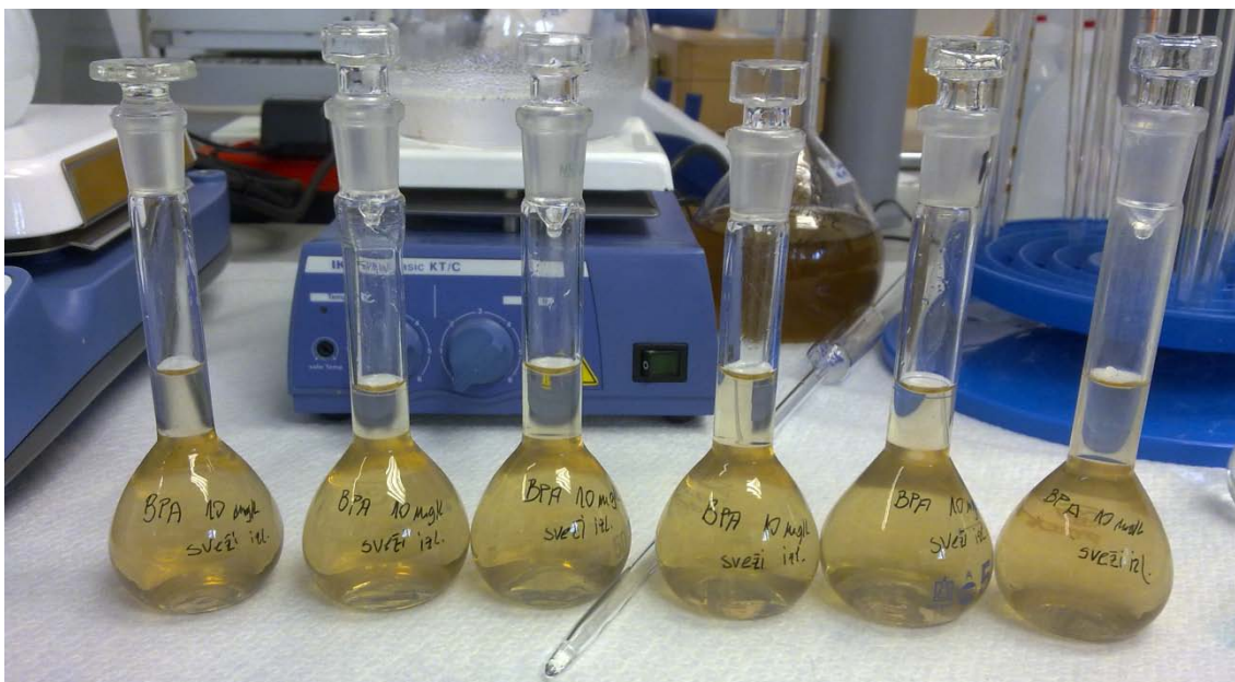
Slika 8: Priprava raztopin svežega vzorca z deponije s koncentracijo BPA 10 \text{ mgL}^{-1}
