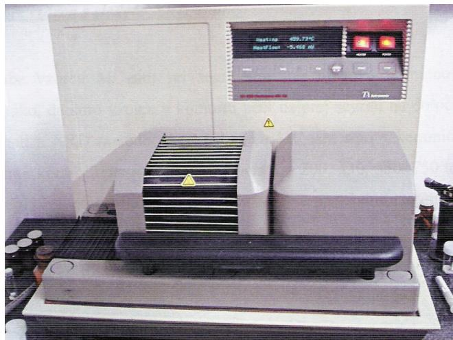
Slika 20: Aparatura za termično analizo SDT 2960
