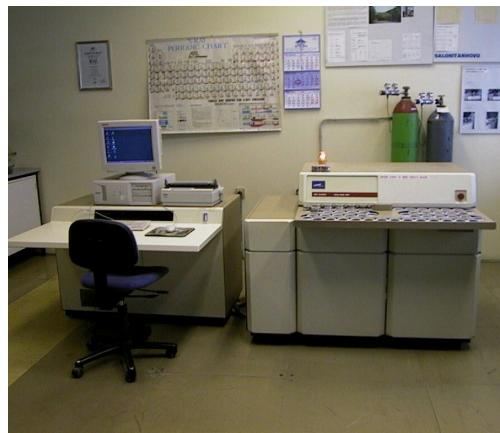
Slika 11: Rentgenski fluorescenčni analizator ARL 8480S
