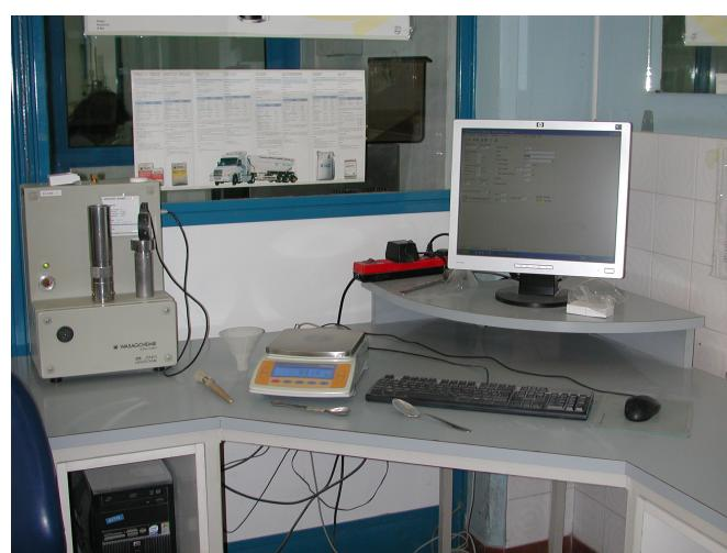
Slika 13: Naprava Blaine Star za določanje specifične površine cementa
