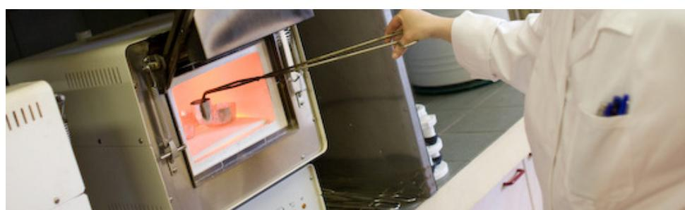
Slika 9: Električna žarilna peč
