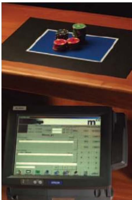
Slika 15: Bralna enota RFID-žetonov na blagajni in računalniška aplikacija (RFID gaming chips, 2009)
