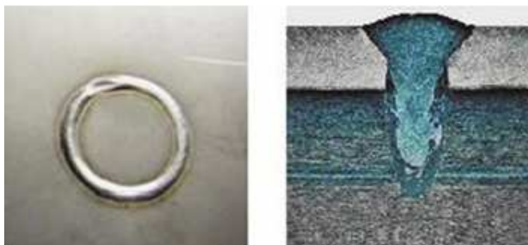
Slika 7: Izgled in presek laserskega zvarnega spoja hladilnega plašča s posodo
