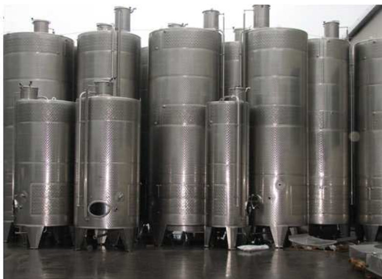
Slika 1: Primer posode za prehrabeno industrijo s hladilnim plaščem
