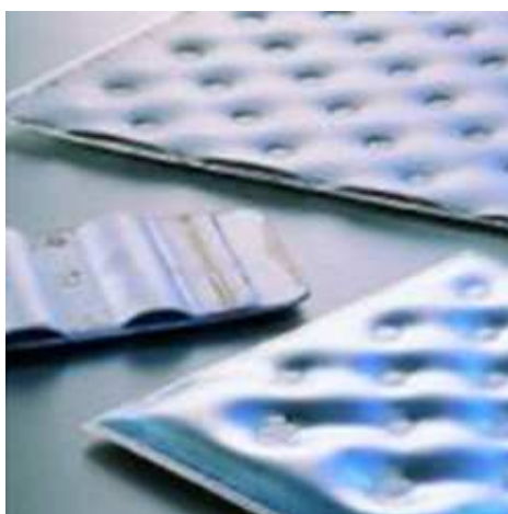
Slika 5: Hladno plastično deformirana (napihnjena) zgornja pločevina
