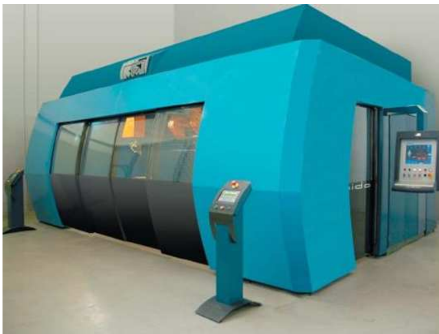
Slika 28: 3D CNC varilni sistem
