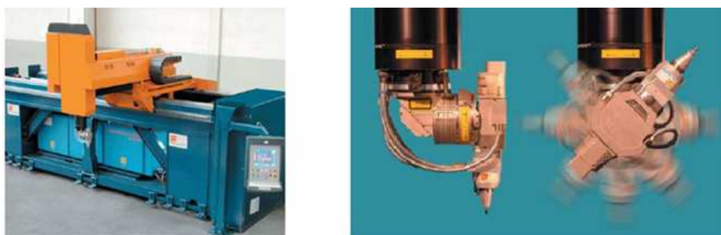
Slika 15: Premik optike za prenos, oblikovanje in fokusiranje laserskega žarka
