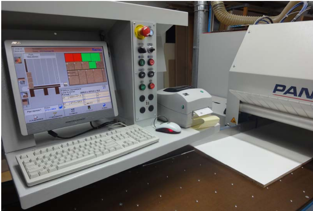
Slika 13: Tiskanje etiket ob končanem razrezu posameznega elementa
