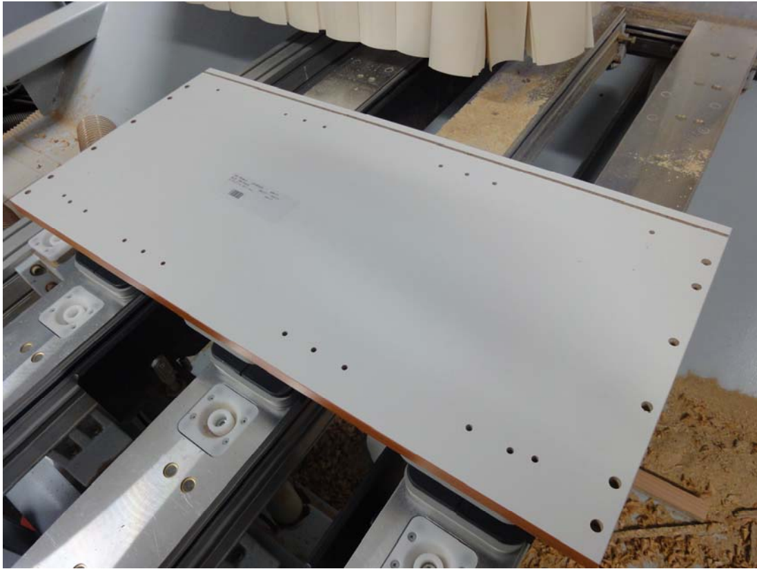
Slika 16: Konstrukcijske izvrtine stranice omare, izdelane na CNC obdelovalnem centru
