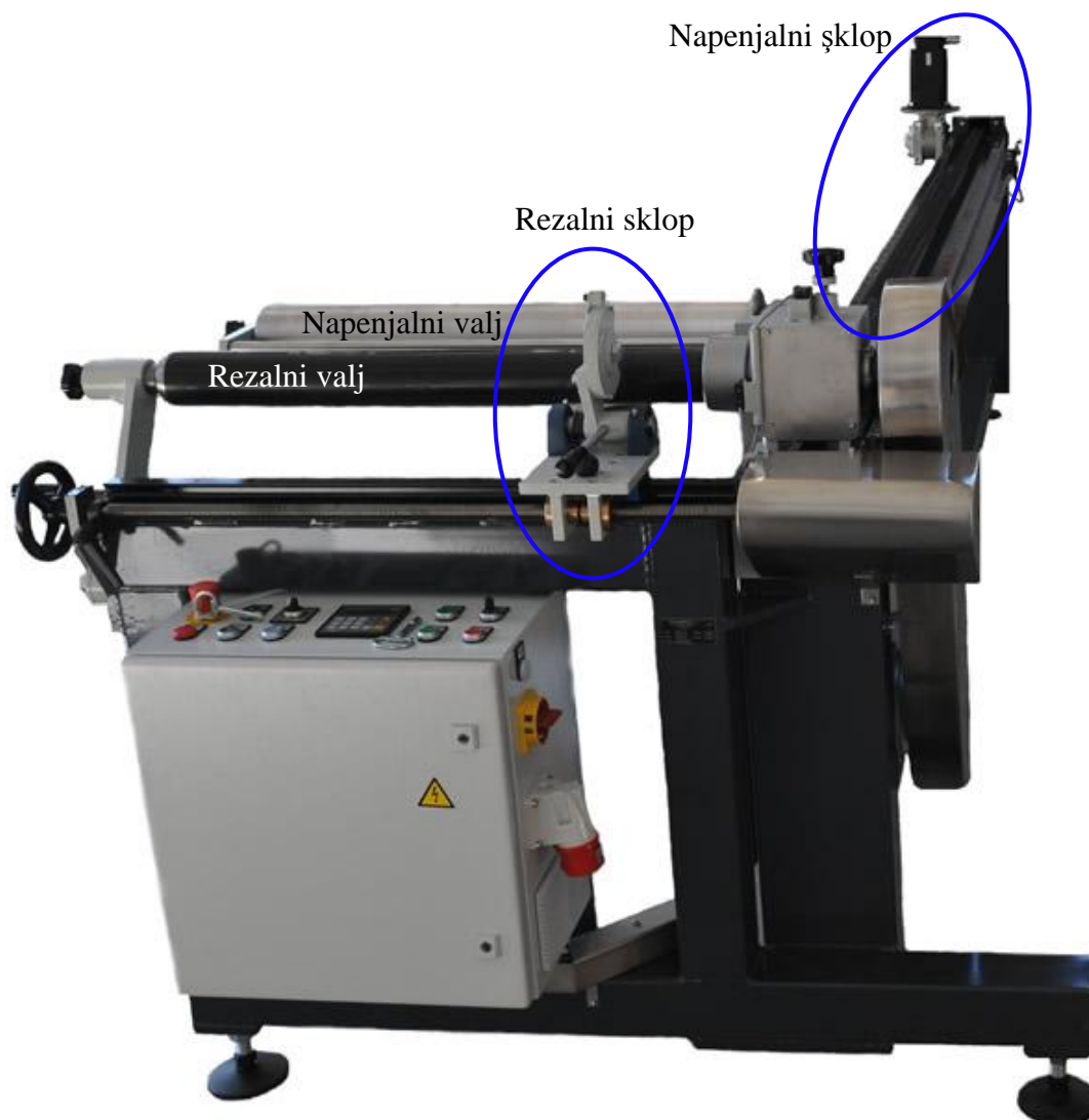
Slika 2: Obstoječi stroj za rezanje jermenskih rokavov
