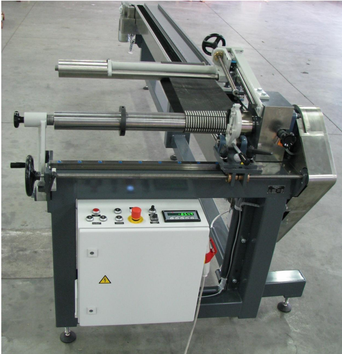
Slika 1: Stroj za rezanje jermenskih rokavov z nameščenim obdelovancem
