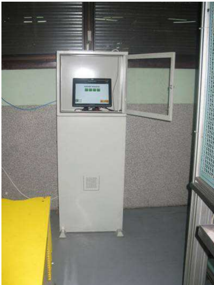
Slika 14: Panel na delovnem mestu v zaščitni omari, ki ga varuje pred aerosoli
