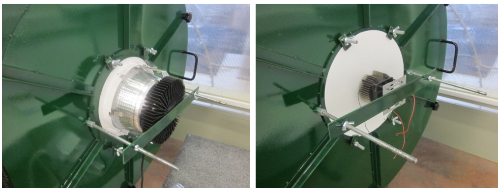
Slika 40: Montaža večje svetilke (LED downlight) in manjšega LED motorja (merjenec 3) na nosilec 2\pi .
