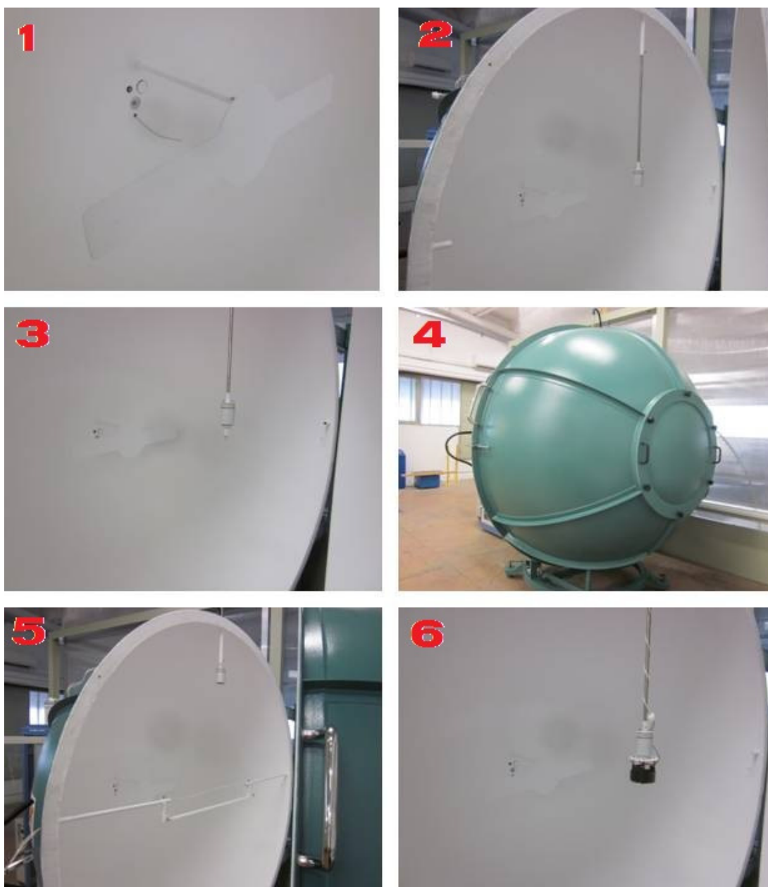
Slika 26: Komponente integracijske sfere pred nadgradnjo.
