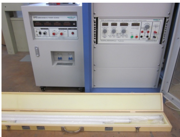
Slika 35: AC stabilizator napetosti, visokofrekvenčna standardna predstikalna naprava in kalibracijske sijalke T8 treh dolžin.
