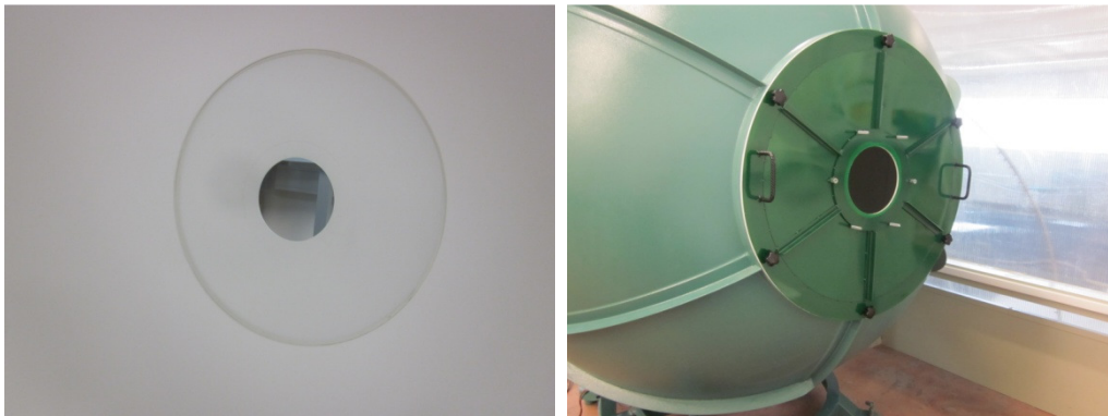
Slika 39: Nosilec geometrije 2\pi z notranje in zunanje strani sfere.
