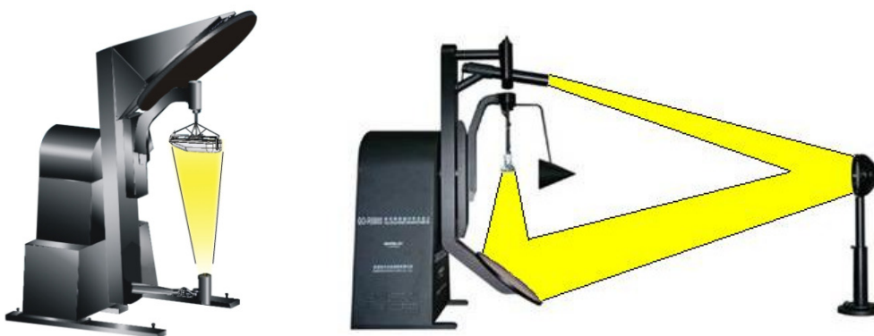
Slika 12: Fotogoniometer tipa C z dvema ogledaloma in dvema senzorjema.
