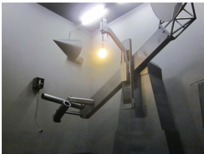
Slika 43: Montaža merjenca 1 na fotogoniometer.
