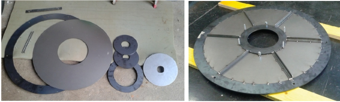
Slika 38: Potek izdelave dodatnega nosilca za geometrijo 2\pi .
