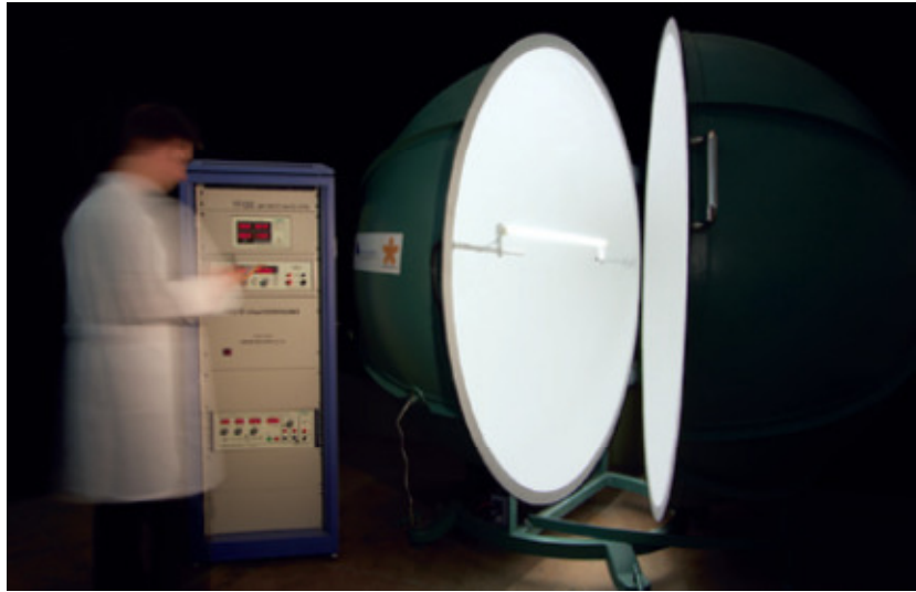
Slika 25: Integracijska sfera premera 2 m podjetja Intra lighting, d. o. o.
